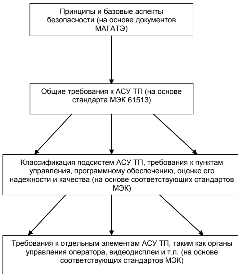
Иерархическая структура нормативных документов для АСУ ТП АЭС
